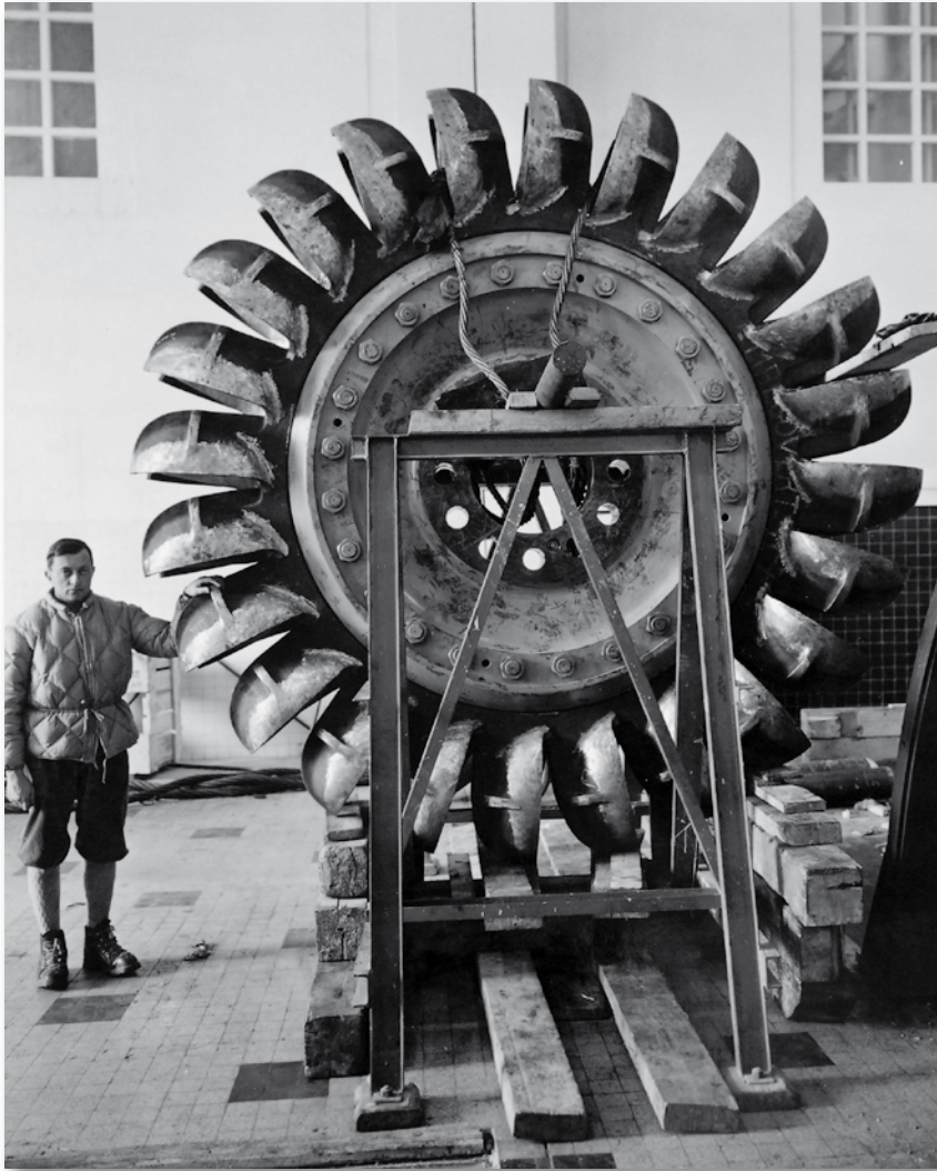
Centrale de Malgovert, la turbine Pelton (coll. Denis Varaschin)
