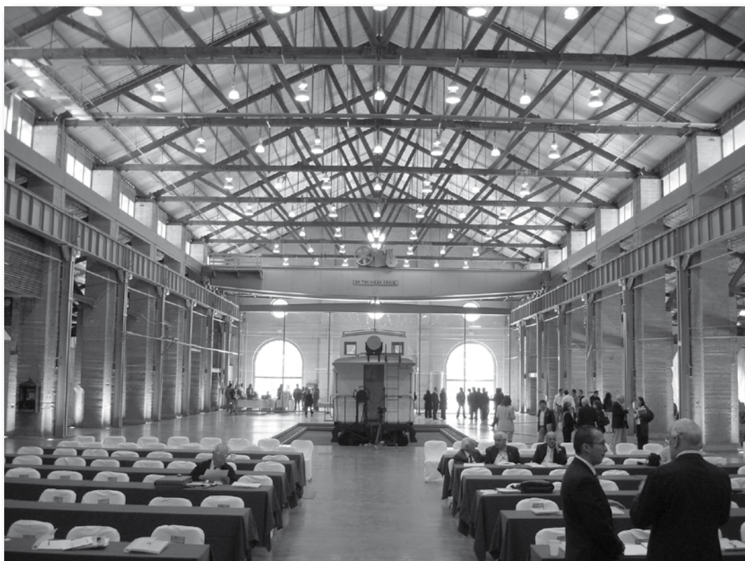
Les ateliers ferroviaires d'Agua Calientes (Mexique). Ce sont les plus vastes d'Amérique latine (90 ha environ). La halle de réparation des locomotives a été transformée en salle de congrès. On a laissé en place le pont roulant qui supportait des charges de 60 tonnes. (Photo GDF, février 2008)
