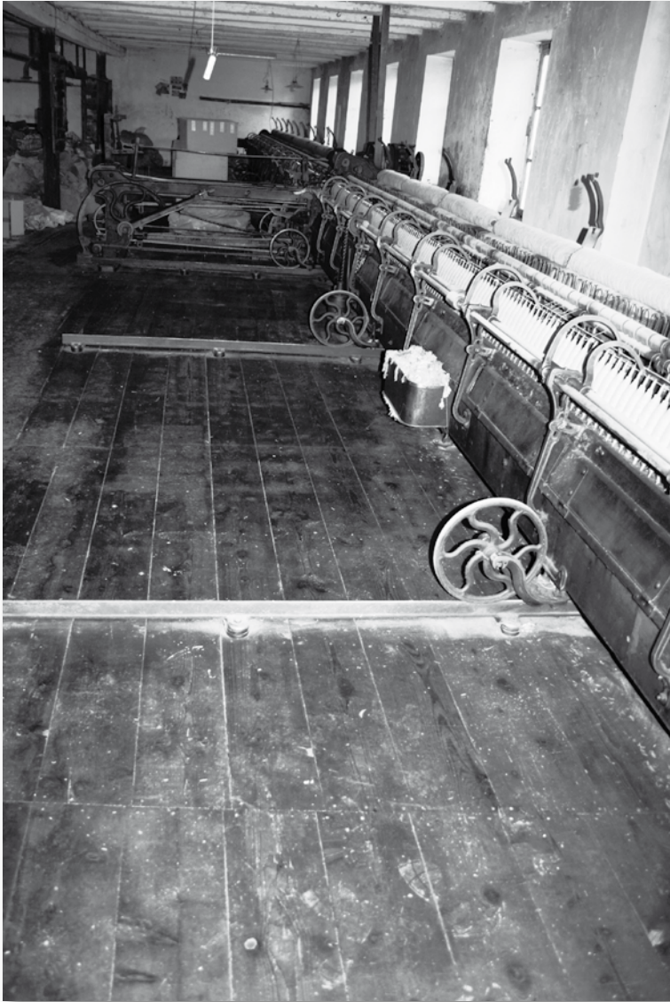
Métier à filer self-acting Brooks & Doxey Manchester, 1897, dans la filature Ebel à Wasselonne. © Pierre Fluck
