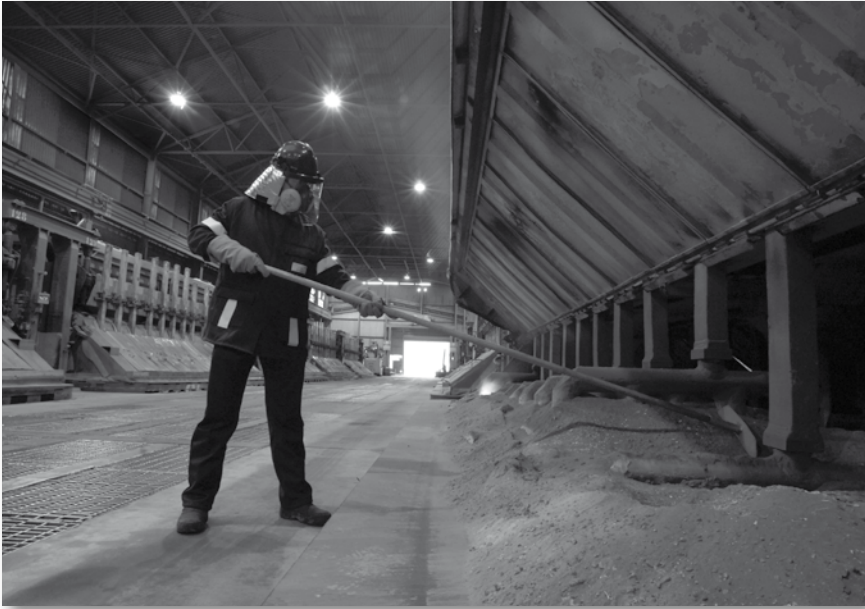
Dans un hall d'électrolyse au XX e s. Les conditions de travail des ouvriers se sont considérablement améliorées depuis 1889. L'atmosphère des halls d'électrolyse est devenue respirable grâce au capotage des cuves et au traitement des effluents gazeux. La tenue des opérateurs le protège aujourd'hui efficacement des risques de brûlures et d'inhalation de poussières toxiques lorsqu'il doit intervenir directement sur la cuve. (Coll. Alcan).
